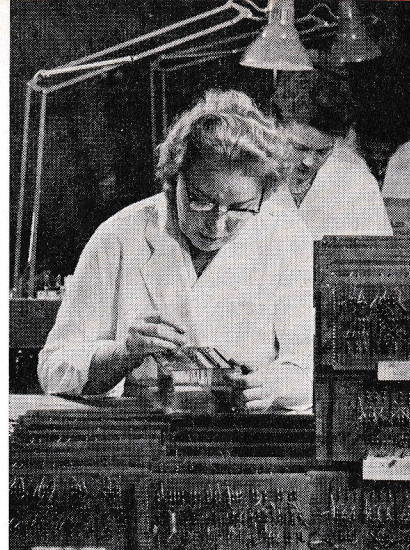
Kort med tryckt ledningsdragnings serie tillverkas och monteras enligt löpande band-principen.
