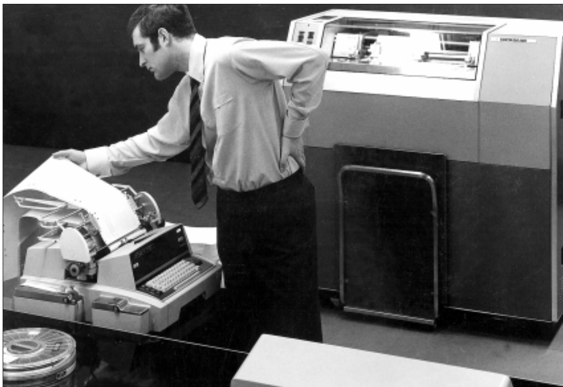
Konsolskrivmaskin och radskrivare till D22.
