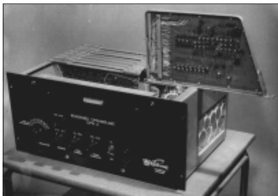
OMV-2 för omvandling av kontinuerliga signaler till digitala värden och vice versa.
