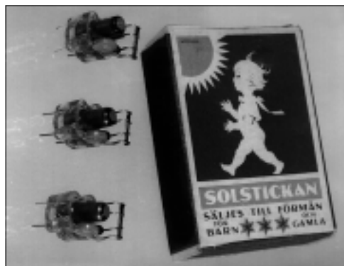
Enhetskretsens komponenter svetsades ihop med fyra fogar utmed en liten balk för ökande av tillförlitligheten.
