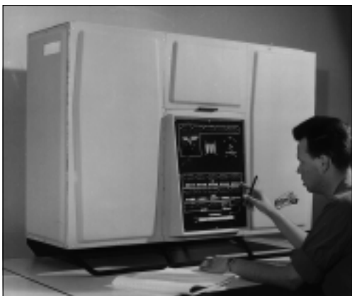
Göran Sundqvist, senare anställd på Skandinaviska Elverk, stod för de mest avancerade tillämpningarna för navigeringskalkylatorn Sank alias D2. Datamaskinen hade en skylt "Sank", som användes vid militära besök, och en skylt "D2", som användes då civilister var i antågande.
