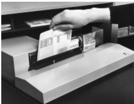
Det centrala tekniska problemet med bankskrivare är att de ska klara bankböcker med olika tjocklek. Bilden visar Datasaabs storsäljare 5808.
