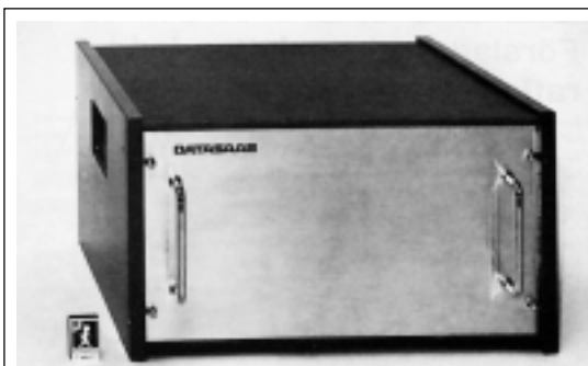
DATASABs nya datorer typ D5 har mycket små ytterdimensioner genom den kompakta inre uppbyggnaden med tjockfilmsmoduler. En D5-dator är inte större än en normal resväska.
